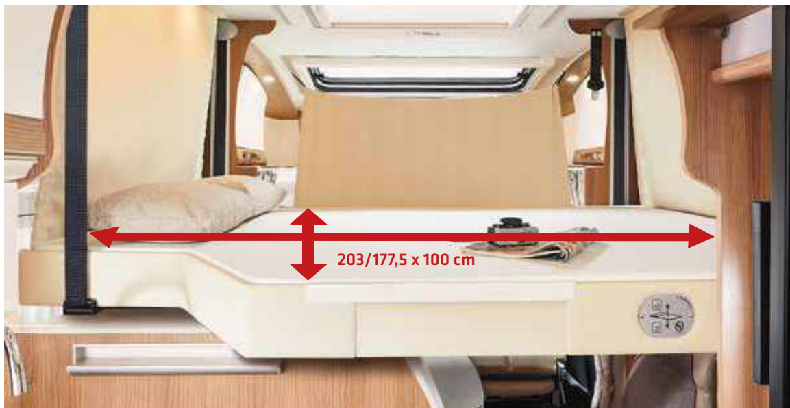
▲ Optional: letto basculante centrale ad azionamento elettrico, grande superficie, altezza interna sotto il letto in posizione giorno 184 cm (escluso T 430 LE).
