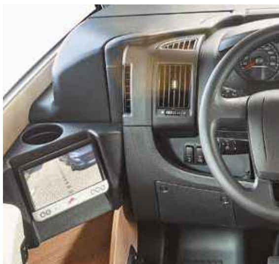
▲ Per tenere sempre tutto sott'occhio: monitor della retrocamera in posizione senza riflessi (optional).
