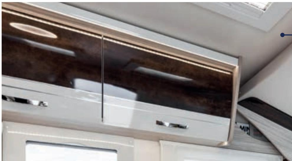
Pensili installati lasciando spazio dalla parete del camper. L'aria si distribuisce in modo uniforme evitando condense e muffe.
