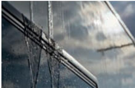
Test di impermeabilizzazione contro le infiltrazioni al 100% dei veicoli usciti di produzione, prima della consegna.
